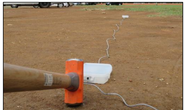
Figura 4. Sistema EDMO, generación de las ondas con un mazo de 36 N.
