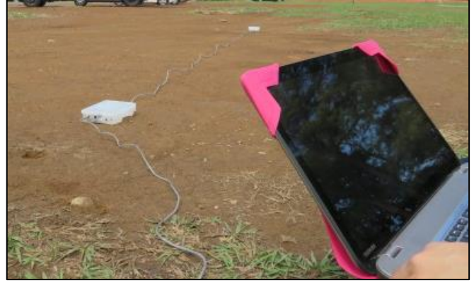
Figura 5. Sistema EDMO, sondeo en suelo usando dos sensores dispuestos de manera lineal.
