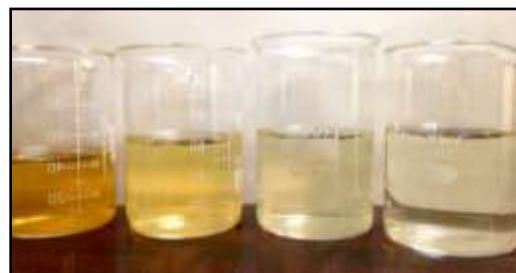
Figura 2. Etapas del residuo de la limpieza de las escamas (biofiltro).
