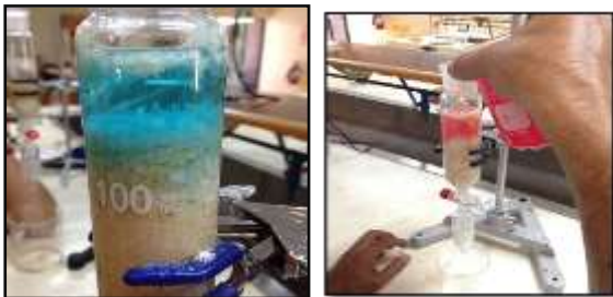
Figura 3. Tratamiento de efluentes sintéticos con azul de metileno y con sangre
