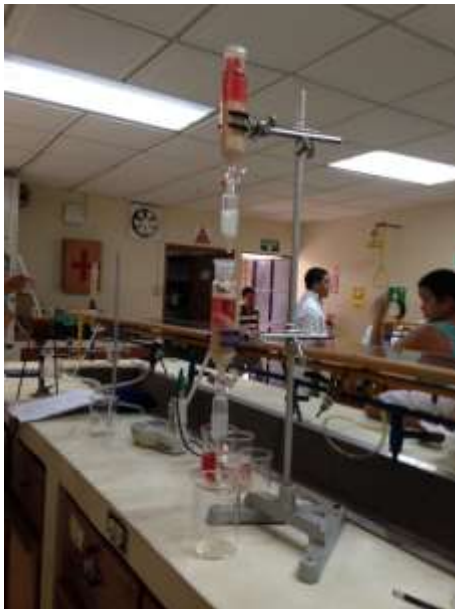
Figura 6. Disposición de biofiltros en serie para el tratamiento de efluentes con pigmentos orgánicos de origen animal.
